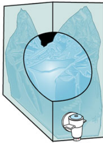
Σχήμα 2 Σχηματική αποϊκόνιση συσκευασίας bag in-box (Πηγή: rapac company)
